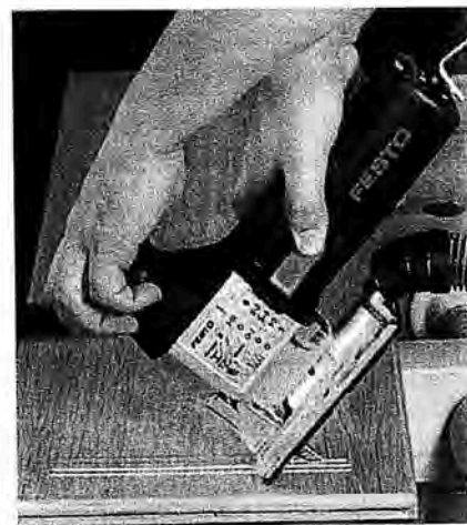
Sierras de calar con funciones muy variadas: contornear siluetas, cortar formas circulares...
