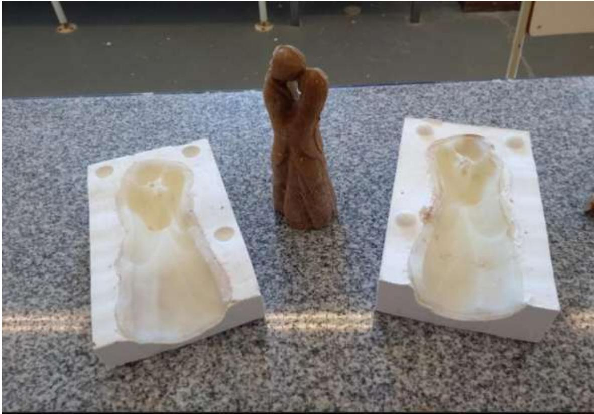
Otro tipo de mordería para replicar modelos a la cera perdida son los moldes de alginato, este tipo de molde tiene una utilidad corta ya que sirve para una sola reproducción y se degrada
