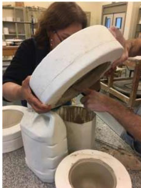
El yeso es un material moldeable, es un “aglutinante hidráulico”, usado para fabricar diferentes moldes a través del colado con agua, lo que le da cierta porosidad a los mismos.
